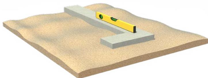
2. Platzieren Sie die Stützmauern auf der tragenden Oberfläche. Verschrauben Sie die Elemente mit den mitgelieferten Materialien.
