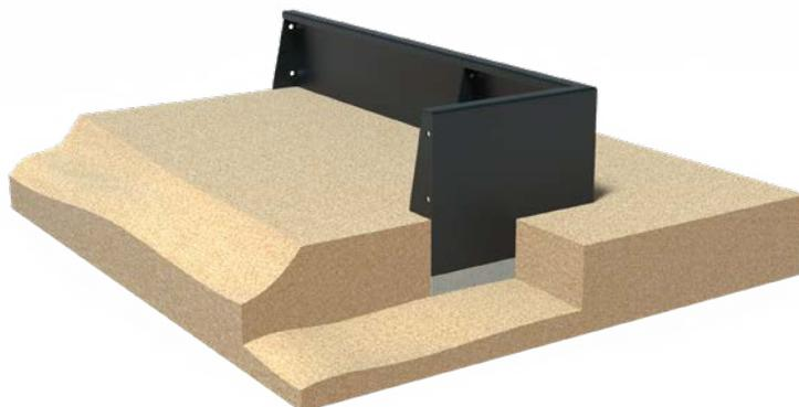
4. Füllen Sie dann die Innenseite der Stützmauer weiter und beenden Sie die Pflasterung.
